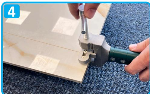
4 С помощью плитколомателя произведите надлом плитки примерно на 2 см с каждой стороны.
