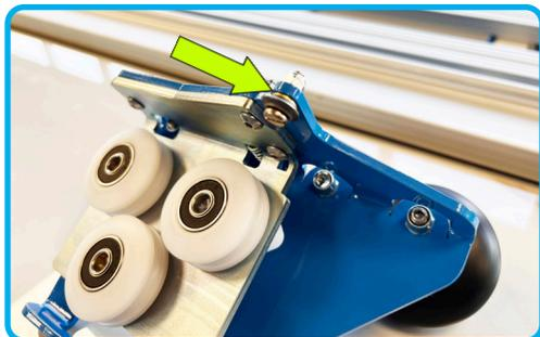
Держите ролики в чистоте. Смазывайте и проверяйте винт крепления алмазного резца. Резец должен иметь минимально возможный зазор, но при этом свободно вращаться вокруг своей оси.
