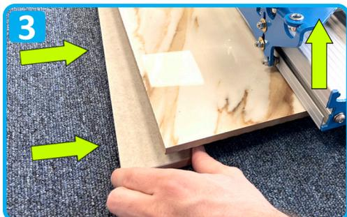
3 **БЕЗ ОТСОЕДИНЕНИЯ ПРИСОСОК** приподнимите направляющую и вставьте подкладку под плитку по всей длине плитки.
