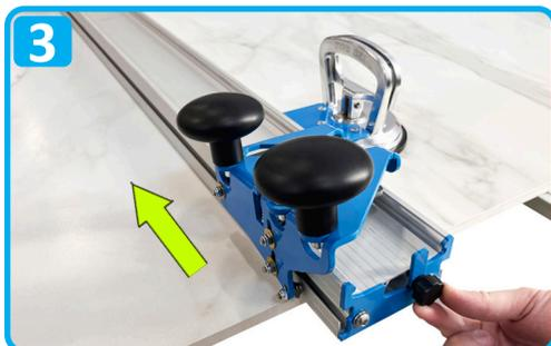
3 Вставьте каретку и поднимите концевой упор. Он предохраняет каретку от вылета при резке.
