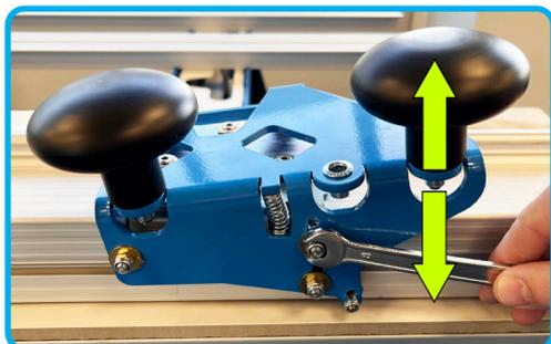
Проверяйте боковой зазор каретки. При необходимости отрегулируйте (затяните) указанные гайки для правильного перемещения каретки. Каретка должна двигаться без рывков. Так же проверяйте натяжение роликов. Каретка не должна иметь люфтов при передвижении.
